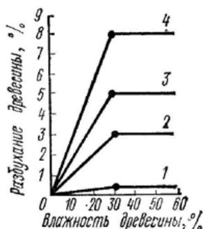
7. На графике представлены деформации при объемной и линейной усушке (разбухании) древесины в зависимости от влажности. Укажите кривую тангенциальной усушки.
