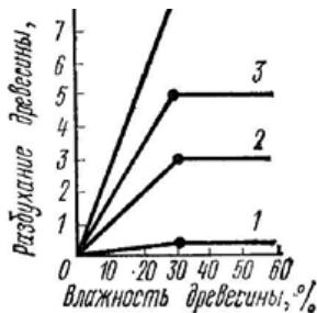
8. На графике представлены деформации при объемной и линейной усушке (разбухании) древесины в зависимости от влажности. Укажите кривую радиальной усушки.
