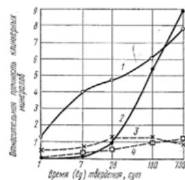
6. На графике приведены сравнительные данные о скорости твердения и относительной прочности основных соединений цементного клинкера (все соединения с добавкой гипса).
