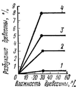
9. На графике представлены деформации при объемной и линейной усушке (разбухании) древесины в зависимости от влажности. Укажите кривую продольной усушки.
